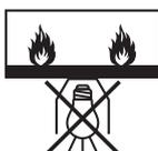
Montage en saillie – montage interdit contre des plafonds ou des matériaux normalement inflammables
