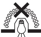
Encastrement – couverture interdite avec une isolation thermique ou acoustique
