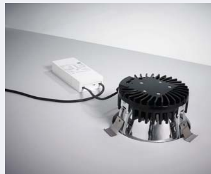
Luxial met led vraagt een inbouwdiepte van slechts 140 mm (inclusief 20 mm voor luchtcirculatie).
