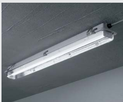
Illustration 38: Medan en E12/136 HFW (med 1 x 36 W lysrör) har ett nominellt ljusflöde på 3 350 lm och ett specifikt ljusflöde på 72 lm/W, kan samma utrustning med ett LED-rör bara komma upp i 1 340 lm respektive 61 lm/W. Även ljusfördelningen blir annorlunda med ett LED-rör (till höger) än med vanliga lysrör (i mitten).
