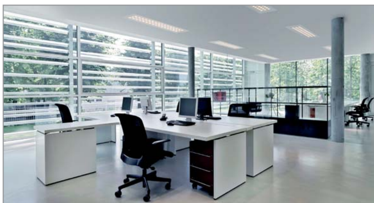
U7-armaturer i en kontorsmiljö har en bibehållningsfaktor på 87 % efter 50 000 brinntimmar (se tabellen).
