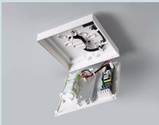
Ytmonterad K1: fäst bara fast monteringsplattan, anslut kablarna och klicka fast fixturen.
