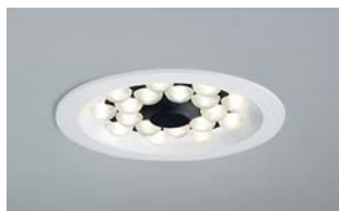
18 lysdioder / Ø 200 mm h 74 mm / håltagning 180 mm
