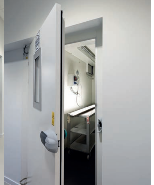
In de klimaatkamer kunnen tests uitgevoerd worden bij temperaturen van -20°C tot 45°C (inclusief vochtigheidsregeling).
