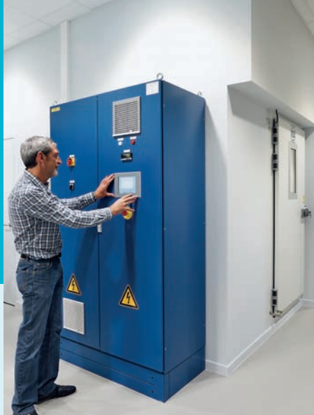
In de klimaatkamer kunnen tests uitgevoerd worden bij temperaturen van -20°C tot 45°C (inclusief vochtigheidsregeling).
