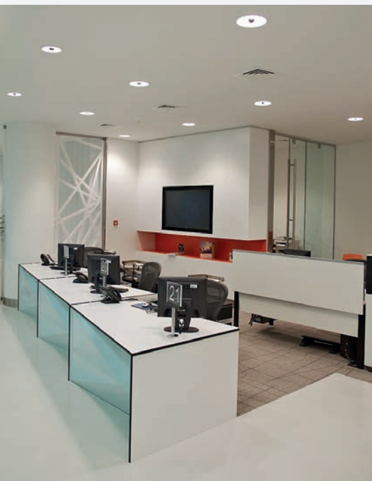
Efficiënte mix: in Dubai Chamber werden o.a. op maat gemaakte fluoarmaturen, D4-downlights met leds en K9-noodverlichting met leds geïnstalleerd.
