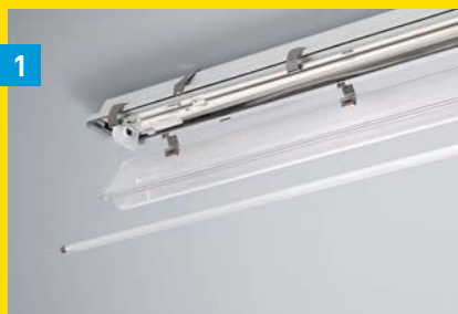
1 Open de beschermkap, verwijder de reflector met fluorescentielampen en koppel de stekker los.
